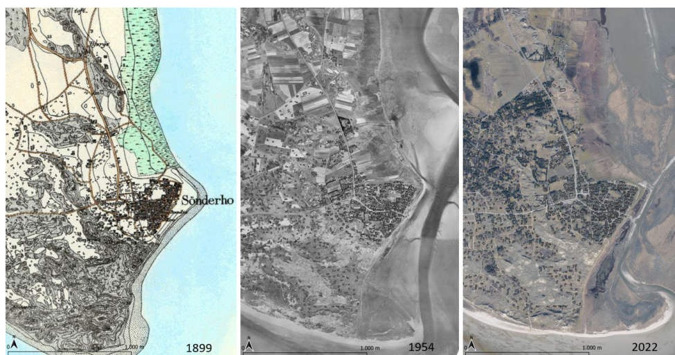
Figur 3 Fanøs sydspids, Hønen, er vokset mere mod øst som en naturlig udvikling af krumodden, se udviklingen fra 1899, 1954 til 2022. Den har en tiltagende naturlig bølgedæmpende effekt på Sønderho's SV-NØ orienterede kystlinje for nuværende digetracé.
