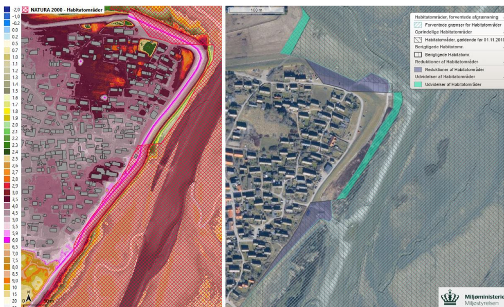
Figur 43 Højdekort med forhøjet Sønderho-dige indlagt i forhold til nuværende Habitatafgrænsning (tv.) og ansøgte reduktioner og udvidelser for Sønderho (th).
